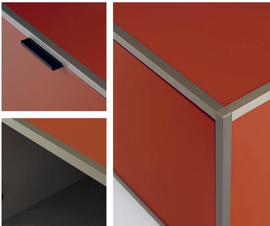
Dita состоит из деревянных панелей, покрытых глиняным лаком изнутри и 16 цветов на выбор для внешней стороны. Стойки изготовлены из массивных алюминиевых профилей 15x15 мм с матовым анодированием и бронзовым покрытием. Бронзово-лакированные литые цинковые ручки соответствуют стойкам.
